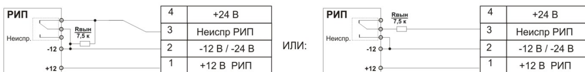
Рис. 8 Схема внешних соединений блока управления с питанием от внешнего источника 12 В
